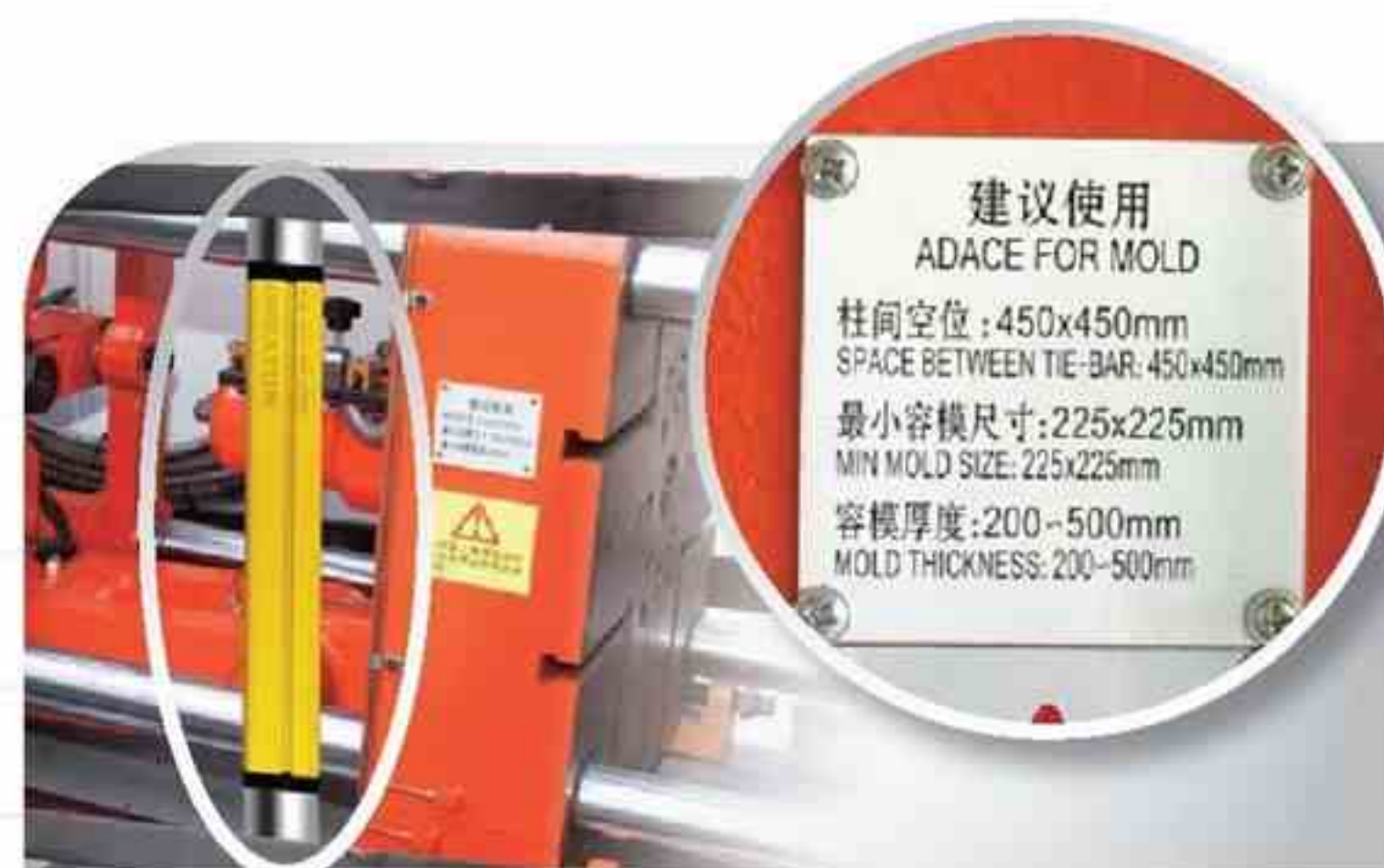
安全光幕开关、模具使用温馨提示 Safety light sensor ,warm advice for mold
